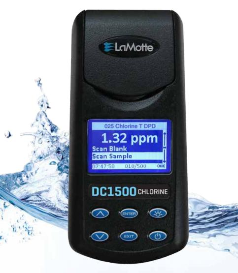
**Chlorine Colorimeter Kit · DPD Liquid**
