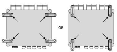
FASTEN THE CONTROLLER TO A FLAT, NON-VIBRATING SURFACE. AVOID METAL SURFACES THAT EXPERIENCE LARGE TEMPERATURE SWINGS.
